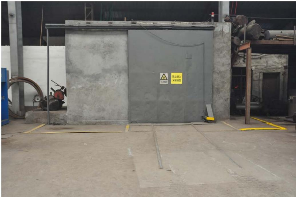
图 6-1 探伤室工件进出门警示灯、警戒线、电离辐射标志及中文警示说明
